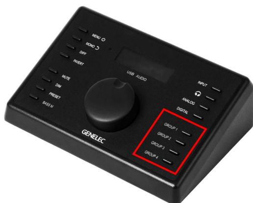
図 20. GROUP ボタンで SAM モニター・システムを選択。
