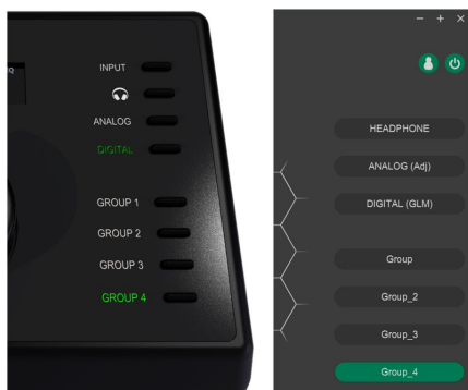
図 8. 4 つの GROUP ボタン (左) にて、GLM ソフトウェア画面の上から 4 つのグループ (右) を選択できます。
